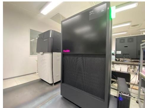
かずさDNA研究所は、2017年10月にパシフィック・バイオサイエンス社製の第三世代のシークエンサー“Sequel”を導入し、一分子シークエンシングの受託解析を実施しています。これまでの次世代シークエンサーとは異なり、連続で60,000塩基以上の配列を読み取ることができ、PCRを経ずに解析することができるため、新規ゲノム解読や高次倍数性をもつ植物などのゲノムの解読で活躍しています。
