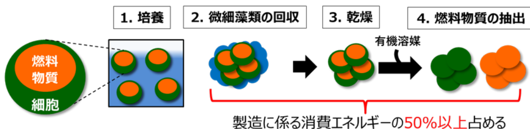
図1 従来のバイオ燃料製造フロー
