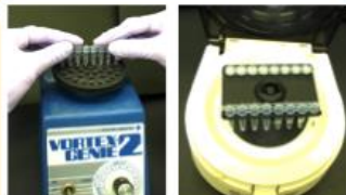
⑥ボルテックス（左）で希釈サンプルをよく混合し、卓上小型遠心機（右）で液を集め、98℃で2分加熱すると完成です
