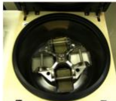
④プレート遠心機で遠心して、固形物と上清を分離
