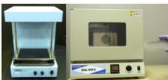
③プレートシェーカー（左）でサンプルを振とうした後、恒温器（右）で60℃・30分間反応させる
