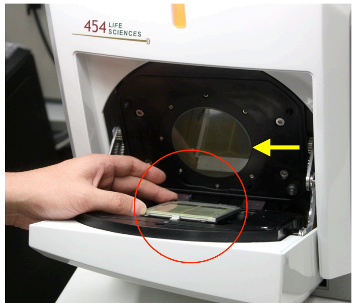
図2：次世代DNAシーケンサーの試料装着部。中央の○内の一辺10センチほどの板状のプラスチックには直径29マイクロメートルの微小な穴が160万個開けられており、その一つ一つにビーズに結合した試料DNAの断片が入っている。DNAの合成反応はこの微小な穴の中で行なわれ (図1)、その結果得られる膨大な量のシグナルがCCDカメラ (黄矢印) で収集される。
